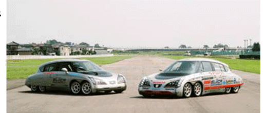
2台のエリーカ：最高速挑戦車A型/加速性能重視のB型
